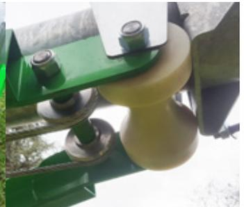
*Système de levage (câble avec poulie & roue téflon)*
