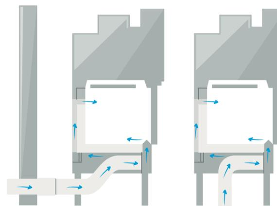
Raccordement direct à l'extérieur (sur tous les simple face) et post-combustion (sur F 800 H, F 800 I, toute la gamme «I»)
