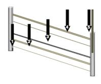
Positionner sur la dernière lame le profilé en U de finition. Si besoin glisser le petit closoir de finition Insérer dans les feuillures non utilisées des poteaux un closoir de finition en le faisant glisser par le haut du poteau (5).
