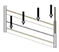
Positionner sur la dernière lame le profilé en U de finition. Si besoin glisser le petit closoir de finition.
