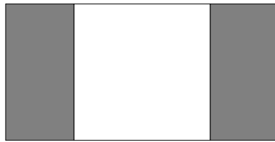
Abb. 8.1: Kaptonstück der Größe 4x2 cm mit aufgedampften Kupferelektroden
