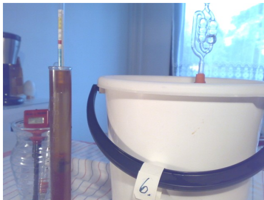
KUVA 6 Hiivauskokeessa käymisastiana oli vesilukolla varustettu kannellinen muoviväpöri.
