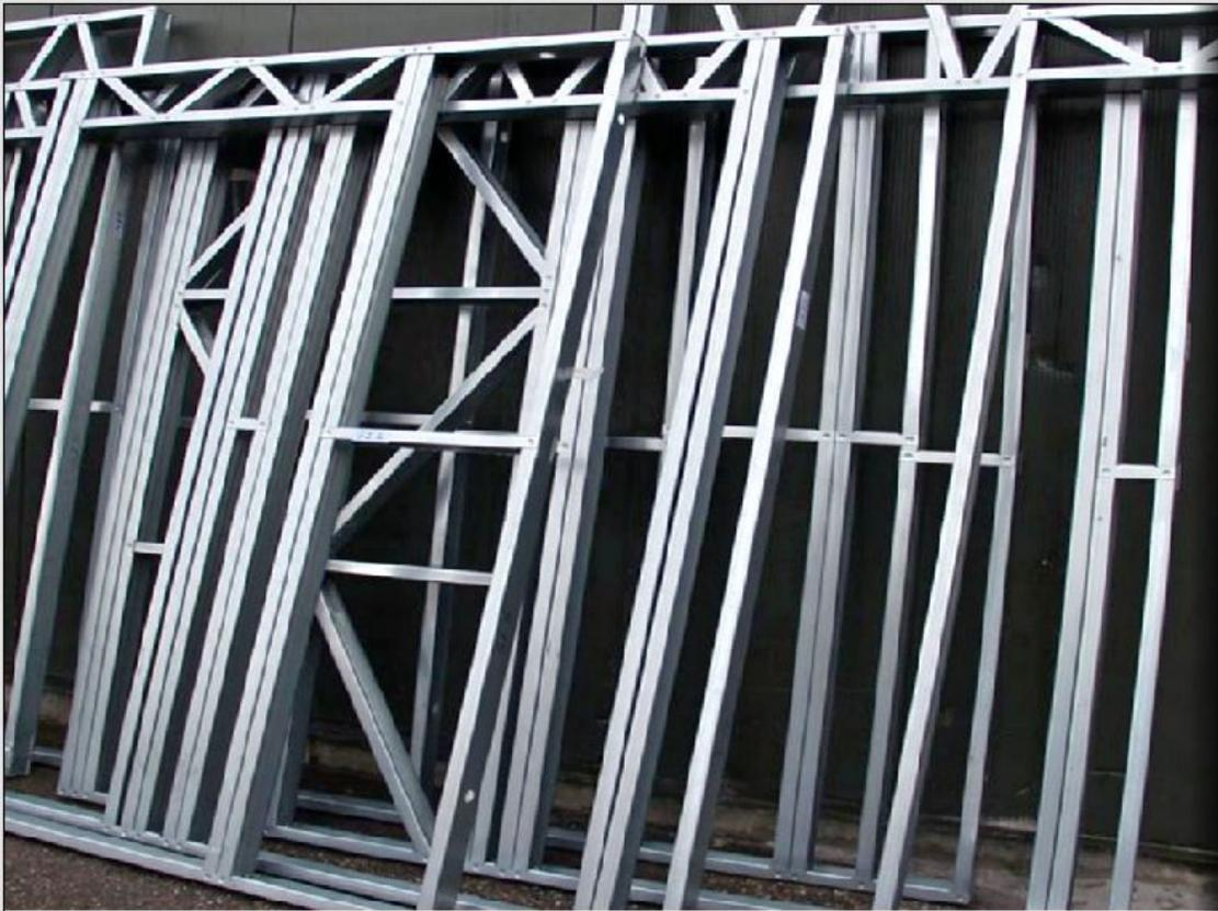
Les profils variant aussi en largeur, en fonction des calculs des contraintes architecturales du projet, sont **pré-assemblés en usine** afin d'en faciliter le transport et la mise en oeuvre, *les dimensions usuelles pour des maisons "standards" (de plain-pied ou R+1) étant de 10cm en murs et de 20cm en planchers pour une épaisseur de 1mm.*
