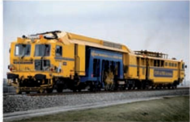
Linie 132, Stopfmaschine UNIMAT 09-32/4S Dynamic der Austriarail
