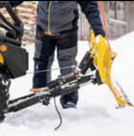
Fjern vinsjkabelen fra føringen. Nå er du klar til brøyte.
