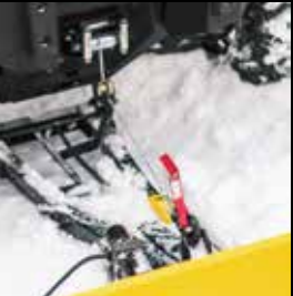
Løft brøyteskjæret til det klipser fast på festeplaten.
