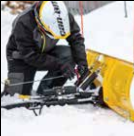
Fest vinsjkabelen til brøyteskjæret med en føringskrok/ruller.
