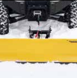
Kjør rett mot brøyteskjæret.
