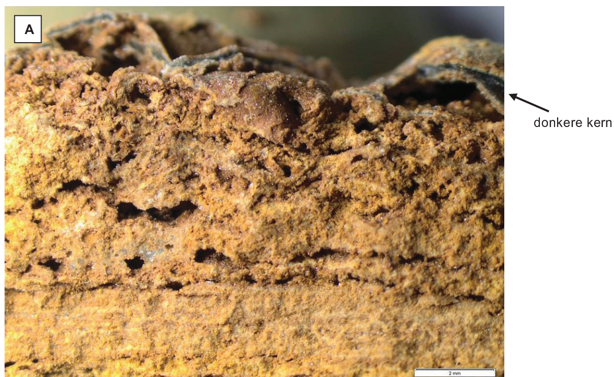
Figuur 16. Het bemonsterde product A had een licht bruine kleur en toonde een duidelijke lagenstructuur. De lagen waren deels iets los van elkaar en het product toonde onregelmatige porositeit. Aan het buitenoppervlak toonden de productlagen deels een donkere meer vaste kern.
