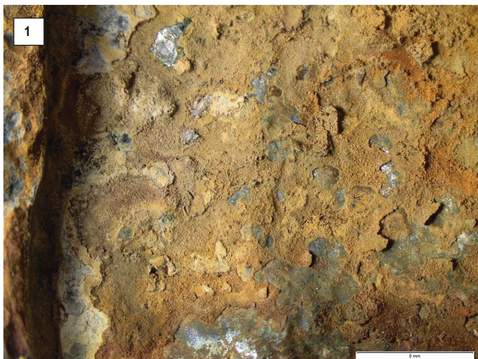
Figuur 9. Aan de pijpzijde was het binnenoppervlak iets gelijkmatiger aangetast. Het pijppoppervlak was relatief vlak en grotendeels bedekt met deels aan de randen loszittend bruin product.
