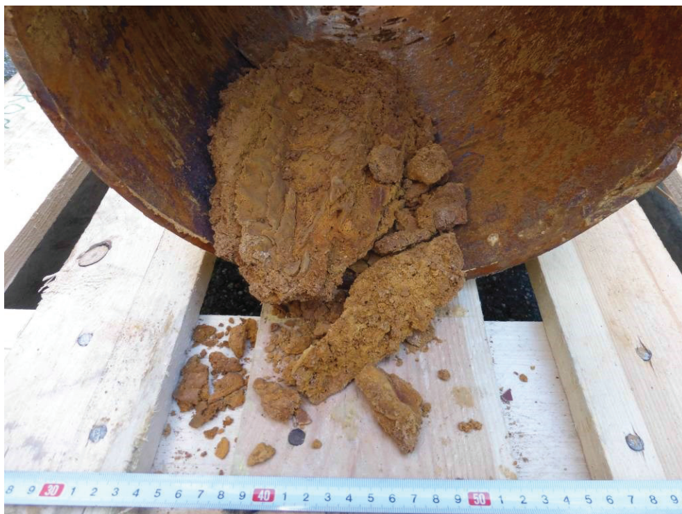
Figuur 5. De binnenzijde van de leidingsectie toonde op de 1 uur positie een restant van het door Shell gerapporteerde volumineuze product. De “koek” van bruin product had een poreus karakter en afmetingen van ~ 330 x 200 x 70 mm. De eerste dagen na aflevering van de leidingsectie had het product een bijtende irriterende geur, die later niet meer duidelijk waarneembaar was.
