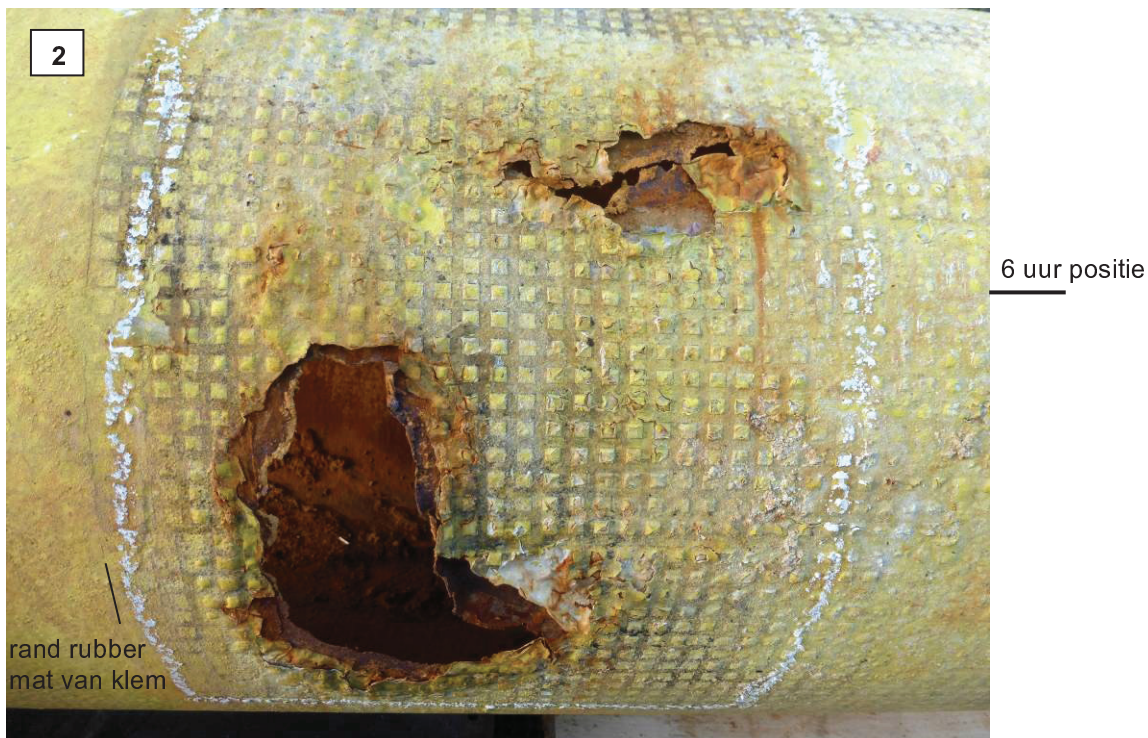
Figuur 2. De lekken waren onregelmatig gevormd en betroffen een groter lek op de 5 uur positie met afmetingen \sim 106 \times 80 mm en een kleiner lek op de 6.5 uur positie met afmetingen \sim 60 \times 15 mm. De coating was rondom de lekken aangetast en had deels losgelaten van het pijpmateriaal. De afdruk van de rubber mat van de klem toonde dat deze aan de zijde van de bocht relatief dicht bij de rand van het grotere lek was geplaatst.
