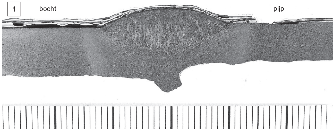
Figuur 19. Na etsen met 10% Nital toonde de macro een uit drie lagen opgebouwde las. De doorlassing stak ~ 2,3 mm uit ten opzichte van het binnenoppervlak aan de bochtzijde. De resterende wanddikte aan de pijpzijde was ~ 6,3 - 6,5 mm en daarmee duidelijk kleiner dan de resterende wanddikte aan de bochtzijde van ~ 8,0 - 8,9 mm. Over het algemeen was het binnenoppervlak iets golvend maar relatief gelijkmatig aangetast. De coatingdikte was afhankelijk van de positie en de gradatie waarin de coatinglagen onderling losgelaten hadden ~ 0,9 - 1,6 mm. Etsmiddel: 10% Nital
