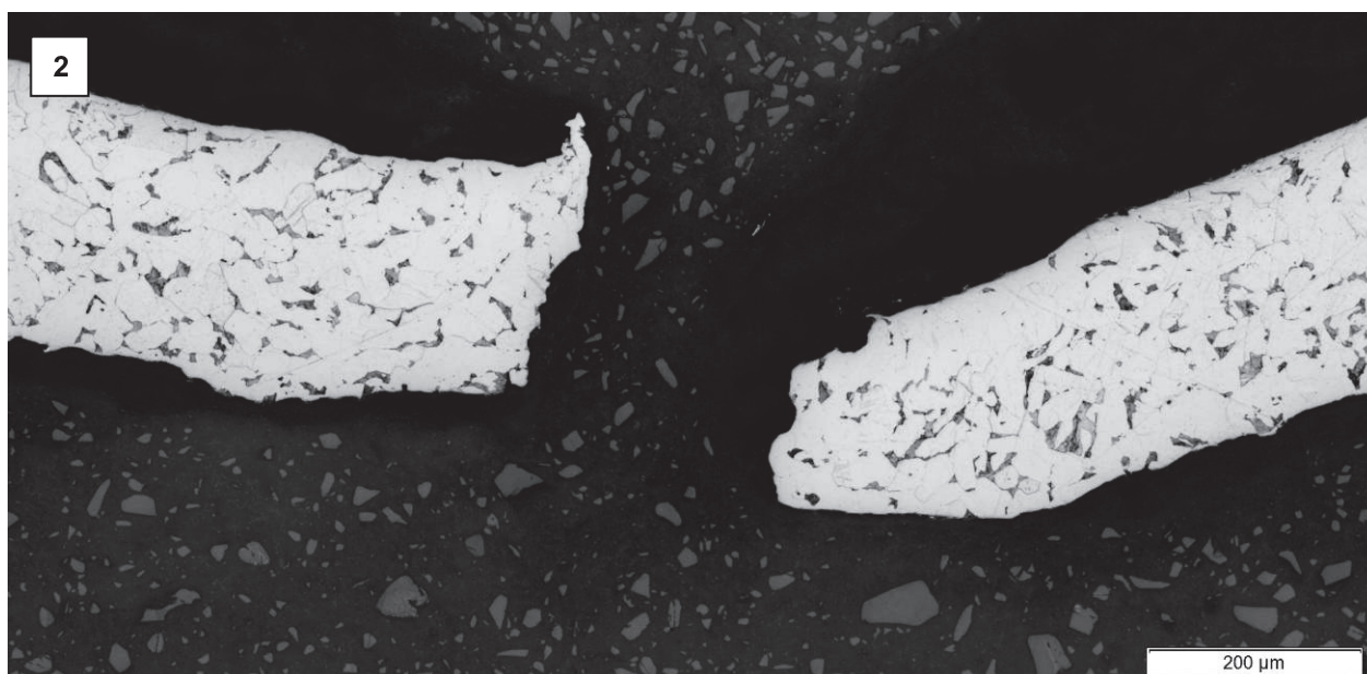
Figuur 23. Op de positie van de scheurvormige uitloper aan de rand van het lek was de wanddikte nog iets groter dan direct bij de lekrand. Aan het buitenoppervlak was een kleine taaie lip zichtbaar als gevolg van lokale overbelasting van de resterende pijpwand. Etsmiddel: 3% Nital
