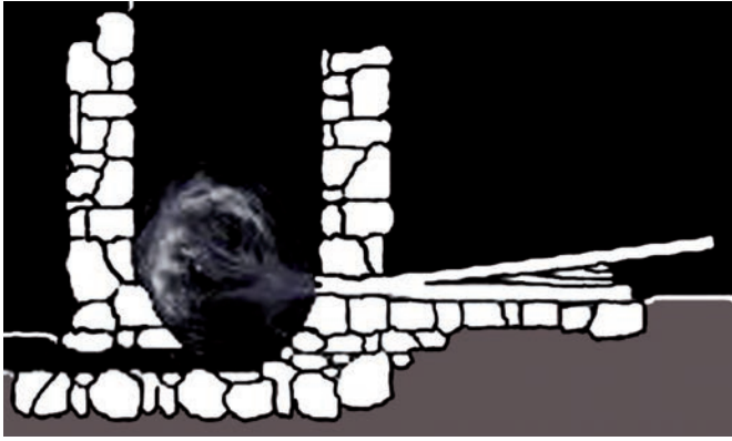
Fig. 5 : Evolution du bas-foyer : massif conique construit en pierres et cimenté avec de l'argile ( www.fargarossell.ad ).
