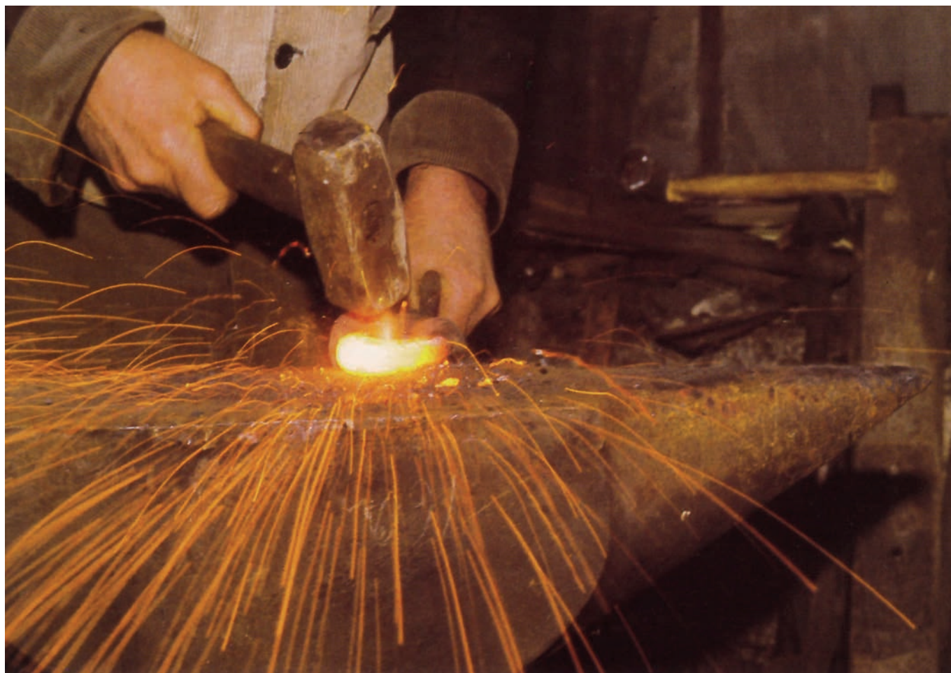
Correction d'un outil à l'enclume. Max Vidrequin, Matagne-la-Grande, automne 1980. Photo. P. Cattelain.
