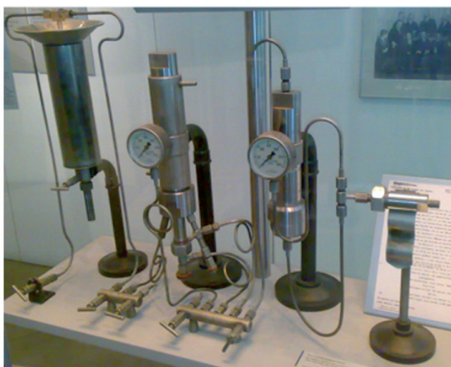
L'un des appareils de laboratoire qu'utilisa Fritz Haber pour synthétiser de l'ammoniac sous haute pression. (Jewish Museum Berlin)
