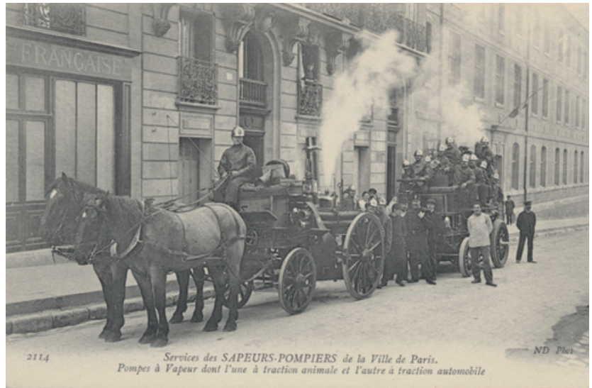
Pompes à incendie à vapeur de Paris. La première est à traction animale, la seconde à traction automobile. Carte postale, vers 1908. Inv. 9778.
