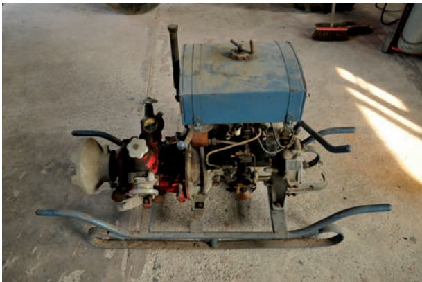
- restauration complète et remise en fonctionnement de la pompe vide-cave Wasterlain 1935 de Nismes (inv. 10089)
