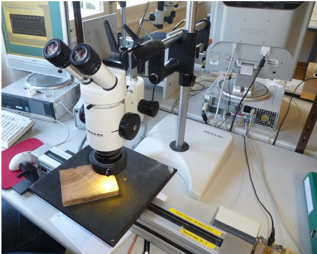
Diagramm 3. Die aus dem Eichenbalken gewonnene Holzscheibe nach dem Schleifen am WSL.
