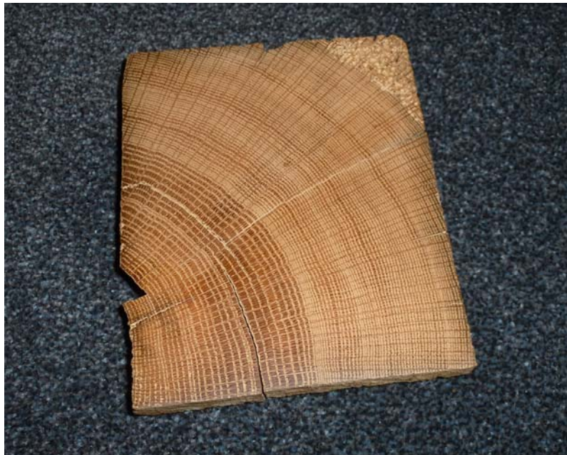
Diagramm 2. Die aus dem Eichenbalken gewonnene Holzscheibe nach dem Schleifen am WSL.
