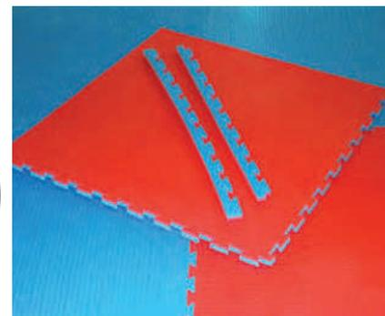
Matière : Mousse de polyéthylène de type EVA à cellules fermées. Finition mousse : Grainage Type Grain de riz sur les recto et verso. Dimensions plaques de 100x100cm. Accessoires : 4 bordures de finition livrées avec chaque plaque. Coloris : Réversible Bleu/Rouge. Existe en 2 épaisseurs : 22mm. et 40mm.
