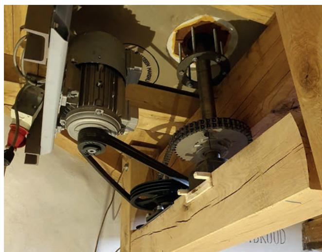
Fig. 66. Le moteur (4 ch-1000 t/m) qui fait tourner la meule à 95 t/m et permet de moudre sans que le vent souffle dans les ailes. Photo © F. Platbrood, décembre 2019.
