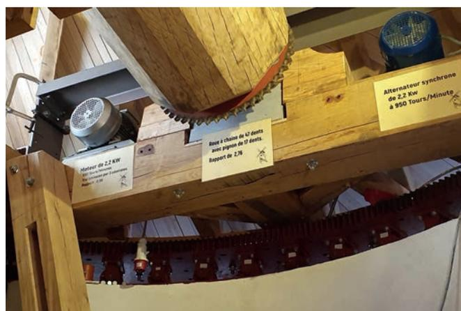
Fig. 67. Le moteur (gris) de 3 ch fait tourner les ailes et peut compléter le vent s'il n'est pas assez fort. À droite, un moteur identique (bleu) transformé en alternateur synchrone qui peut produire de l'électricité, mais aussi servir de frein en mettant en marche les lampes. C'est aussi une installation didactique pour expliquer au public et aux écoles le black-out électrique (production électrique insuffisante pour la consommation demandée). Photo © F. Platbrood, décembre 2019.
