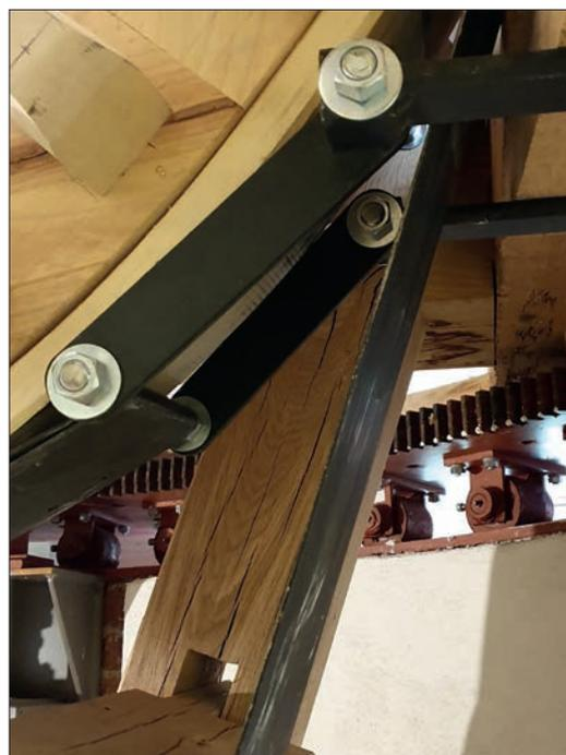
Fig. 62. Frein mécanique à bande. Il doit toujours être bloqué quand le moulin est à l'arrêt et il sert aussi de frein en cas de survitesse quand le vent souffle en rafales.
