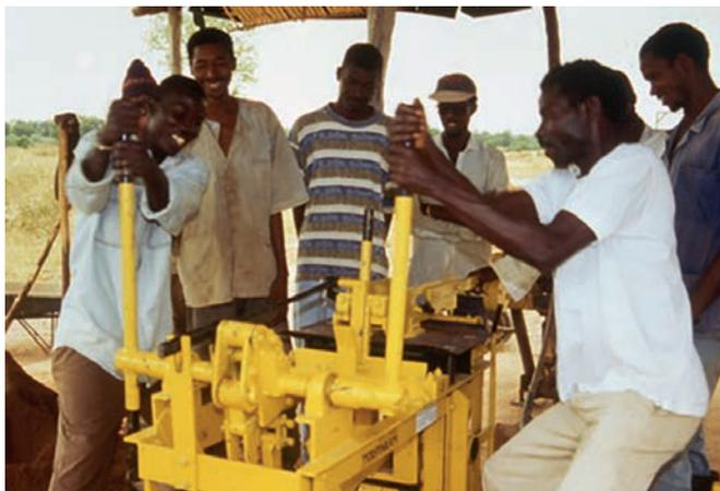
Fig. 94. Le type de presses à briques développées par F. Platbrood. Photo © F. Platbrood.
