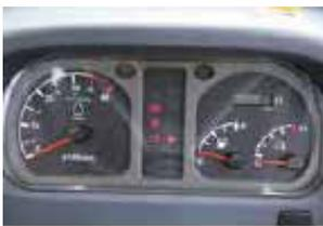
Zentrales Instrumenten Panel mit Kontrollleuchten, Drehzahlmesser, Tank- und Temperaturanzeige. Leicht zu erreichende Tempomatfunktion und elektrische Zapfwelleneinschaltung.
