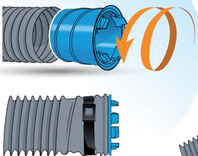
Il vous suffit de visser le piquage dans la gaine dans le sens inverse des aiguilles d'une montre. Fixez ensuite le collier de serrage. Il est recommandé d'utiliser des conduits calorifugés.
