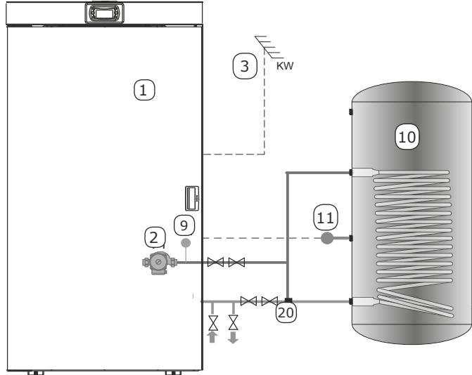
**Configurazione 5** - Caldaia con controllo sul circuito secondario
