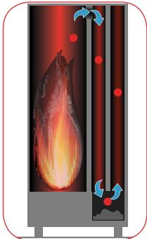
**Fino a 2,5 m di giro fumi** - camera di combustione circolare con rendimenti fino al 95% e con una superficie di scambio pari a 2,5m.
