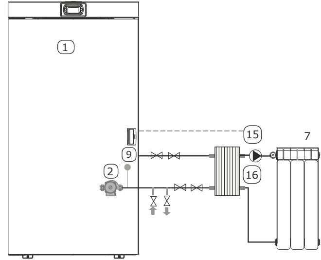
**Configurazione 6** - Caldaia con allaccio a puffer con doppia sonda
