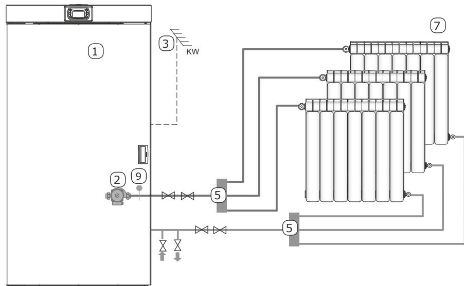
**Configurazione 2 - Caldaia con allaccio a boiler ACS e riscaldamento**
