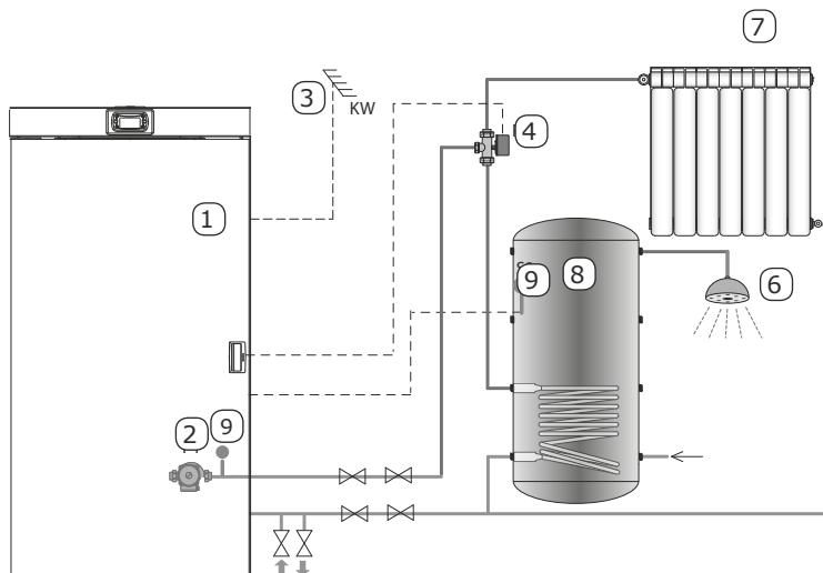
**Configurazione 4** - Caldaia con allaccio a puffer a singola sonda
