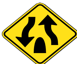
Termina Carretera Dividida
