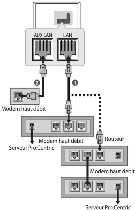
**1** Raccordez le port **LAN** du modem ou du routeur au port **LAN** du téléviseur.
