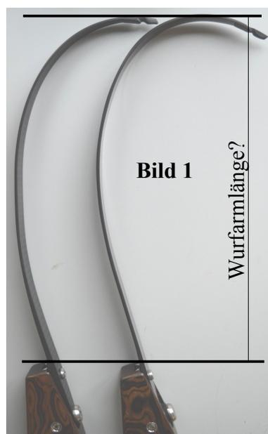
Für die Ermittlung der Wurfarmlänge gibt es verschiedene Methoden, die ebenfalls zu unterschiedlichen Ergebnissen führen. Im Bild 1 scheinen nach der üblichen Messmethode beide Wurfarme gleich lang zu sein. Legt man die Bögen übereinander (Bild 2), wird erkennbar, dass der Wurfarm mit dem stärker ausgeprägten Recurve deutlich länger ist. Damit ist erwiesen, dass die Messergebnisse aus Bild 1 bezüglich der Wurfarmlänge nicht aussagekräftig sein können.
