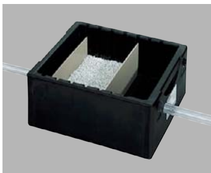
Bild 33: Granulat-Neutralisation für Kondenswassermengen aus Gasfeuerungsanlagen bis 70 l/h, entspricht ca. 500 kW Wärmeleistung
