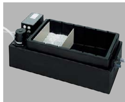
Bild 34: Granulat-Neutralisation mit Kondensathebepumpe – einsetzbar für Kondensatmengen bis 210 l/h, entspricht ca. 1500 kW Wärmeleistung
