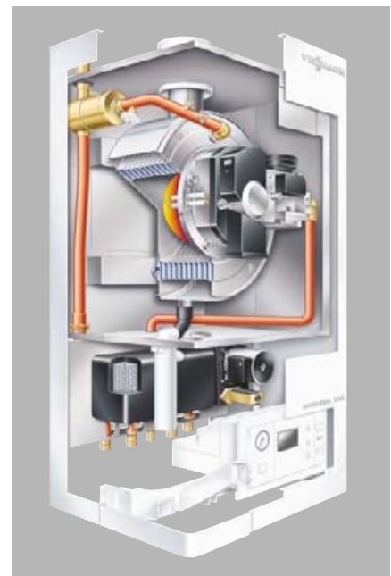
Bild 5: Gas-Brennwert-Wandkessel Vitodens 200 mit Inox-Radial-Heizflächen und Matrix-compact-Brenner, Nenn-Wärmeleistung: 4,5 bis 66,3 kW
