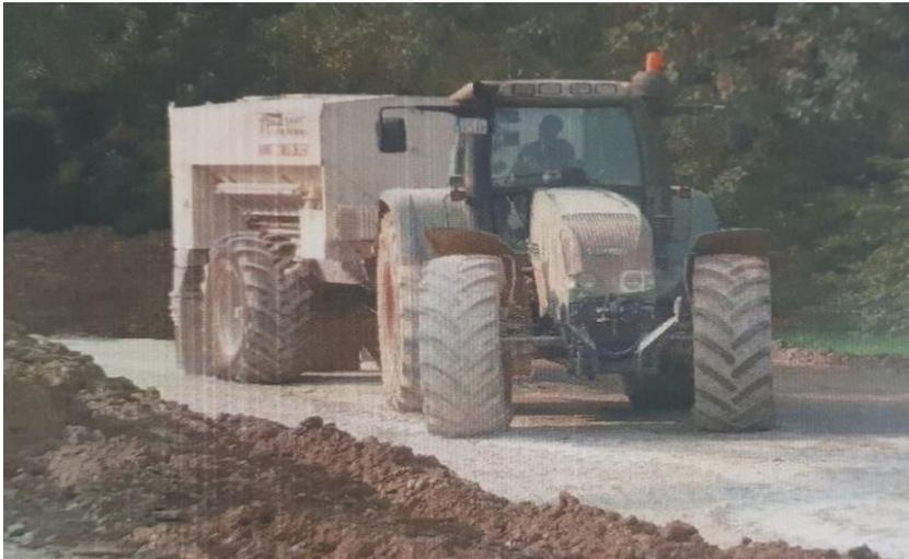
Traktor mit Kalkstreuer für Bodenstabilisierung
