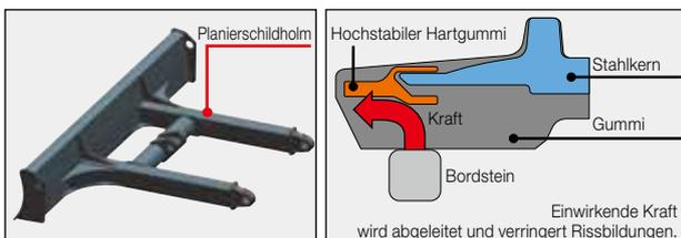
Die Planierschildholme mit Kastenprofil zeichnen sich durch eine hohe Robustheit und Steifigkeit beim Planieren aus. Alle Kettenplatten sind mit Stahlkernen verstärkt. Dadurch sind die Kanten der Kettenplatten beim Überfahren von z.B. Bordsteinen wesentlich belastbarer.
