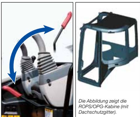
Die Abbildung zeigt die ROPS/OPG-Kabine (mit Dachschutzgitter).
