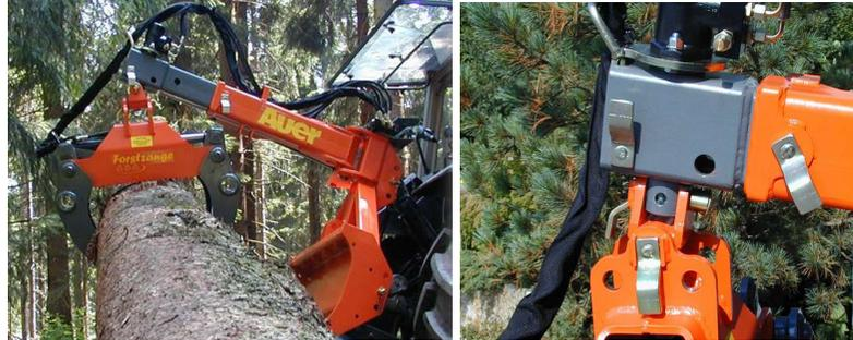
Beim **Rücken bzw. Ziehen von Starkholz** wird der drehbare Greifer **pendelnd gestellt** – damit kann der Greifer auf dem Kreuzgelenk frei pendeln und bringt unverzichtbare Vorteile:
