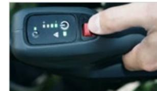
4-stufiger Geschwindigkeitsregler und Rückwärtslauf, um festgefahrene Heckenscheren zu lösen.
