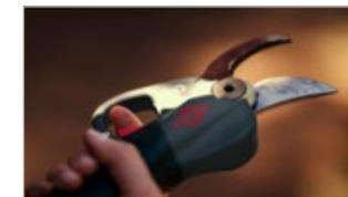
Schneller schneiden: Schere mit dem ersten Druck nur so weit öffnen, wie benötigt – mit dem zweiten wieder schließen.
