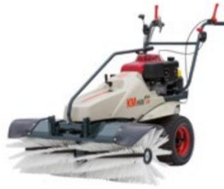
Tempomat für komfortable Bedienung | Hydrostatischer Antrieb für optimierte Leistung unter allen Einsatzbedingungen
