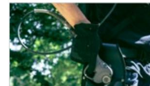
Die flexible Kabelkupplung sorgt für eine sichere Kabelverbindung von Akku und Schere.
