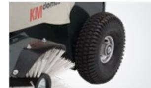
**Große Antriebsräder** – Breite, stark profilierte Räder sorgen für guten Antrieb und erleichtern das Arbeiten im Schnee und auf feuchten Untergründen.
