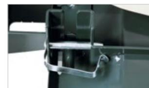
Zur sauberen Aufnahme des Kehrichts lässt sich der Kehrgutbehälter entsprechend der Bürstenabnutzung einstellen.
