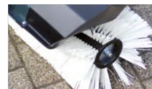
Die Kunststoffabdeckung außen über der Bürste dient als Scheuerschutz und verhindert so Kratzer am Gehäuse.
