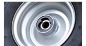
Die Räder besitzen einen Freilauf-Differentialausgleich und Stahlfelgen. Damit es beim Arbeiten mit den Laubsaugern immer rund läuft.
