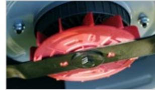
Das Gebläse sorgt für einen erhöhten Luftzug und kühlt den Motor.
