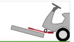
Zwei kugelgelagerte Führungsrollen gewährleisten das Fluchten des Keilriemens auch bei Geländeunebenheiten.
