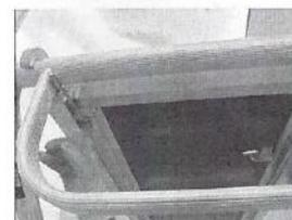
14. Inserire, per ogni piano di lavoro montato, il fermo di sicurezza antisollevamento accidentale del piano stesso.
