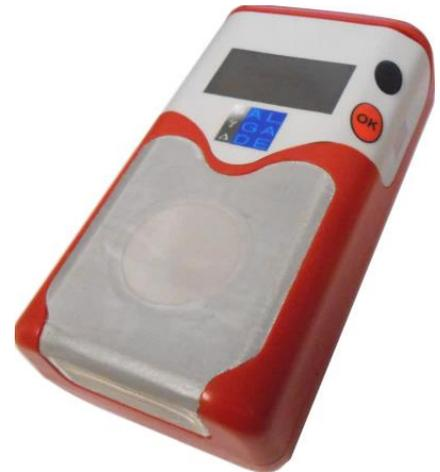
eDPRW donne des résultats fiables et rapides. Il propose une mesure en continu du radon haute sensibilité et une spectrométrie (possibilité de discrimination  $^{222}\text{Rn}/^{220}\text{Rn}$ ), grâce au couplage d'une chambre de mesure optimisée et d'un champ électrique. Le rythme d'acquisition est paramétrable de 15 à 240 minutes.
