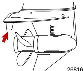
**REMARQUE :** Le réglage de la dérive aura peu d'effets sur la réduction du couple de direction si le moteur hors-bord est installé avec la plaque antivibration à environ 50 mm (2 in.) ou plus au-dessus du fond du bateau.
