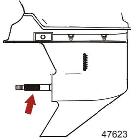
2. Graisser les éléments suivants avec de la graisse 2-4-C avec PTFE ou de la graisse à haute performance.
