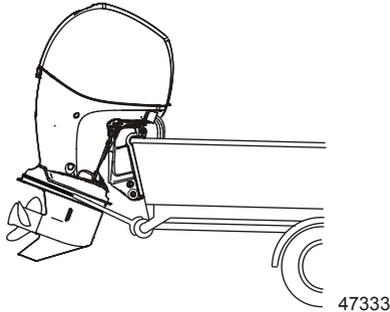
**IMPORTANT : Ne pas se fier au système de trim/de relevage hydraulique ni au levier de support de relevage pour maintenir une garde au sol suffisante pour le remorquage. Le levier de support de relevage du moteur hors-bord n'a pas été conçu pour soutenir le moteur durant le remorquage.**
