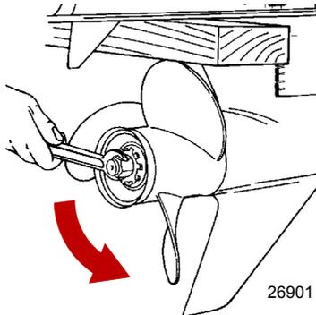
4. Retirer l'hélice de l'arbre en la tirant directement. Si l'hélice est grippée sur l'arbre et ne peut pas être retirée, la faire retirer par un revendeur agréé.
