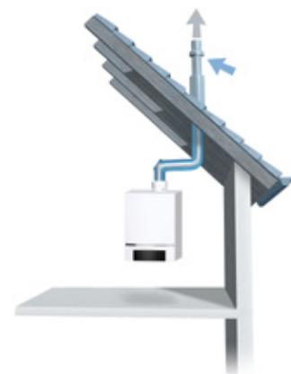
Raumluftunabhängige Aufstellvariante mit Rohr-in-Rohr-Kunststoff-Abgassystem
