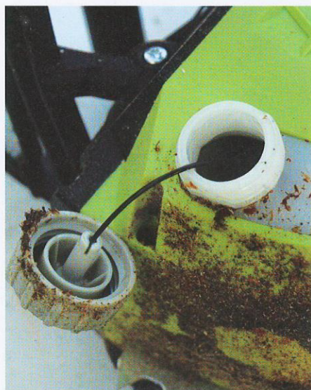
Een verhoogde opening en een dubbele rand in de dop (zoals hier bij de Ryobi) gaan morsen van olie tegen. Wel smeerde de Ryobi de ketting ruimhartig. Vandaar de vervuiling.
