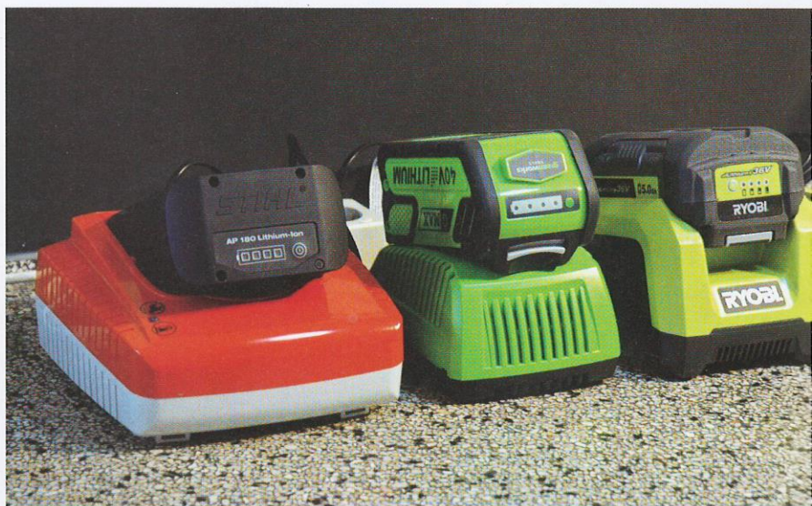
De lader van Stihl (links) is groot, maar heeft een ingebouwde ventilator. Daardoor kan hij snel laden. De laders van de Greenworks (midden) en van de Ryobi hebben aanmerkelijk meer tijd nodig om de accu op te laden. Alledrie accu's werken met vier controlelampjes voor de laadtoestand. De lader van de Ryobi kun je ook eenvoudig aan de wand bevestigen.
