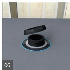
Serrer fermement les joints contre la bague en acier de la base au moyen de l'écrou de verrouillage. Vérifier que le corps de l'écoulement est toujours bien inclus dans le cordon de joint de la vanne.
