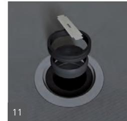
11 Serrer (pincer) fermement le joint d'étanchéité en caoutchouc avec l'écrou de calfeutrage (utiliser un tournevis à tête plate) et finalement installer le châssis en plastique et la grille par dessus (sans adhésif). Le châssis et la grille seront tenus par un joint en coulis une fois que le carrelage débute.
