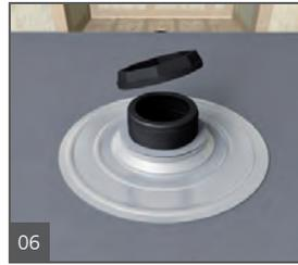
06 Serrer fermement les joints contre la bague en acier de la base du receveur au moyen de l'écrou de verrouillage. Vérifier que le corps de l'écoulement est toujours bien inclus dans le cordon de joint de la vanne. Étaler une fine couche de ciment-colle ANSI 118.4 et la ratisser vers l'entrée avec une truelle dentelée de 6 mm x 6 mm (1/4 po x 1/4 po).
