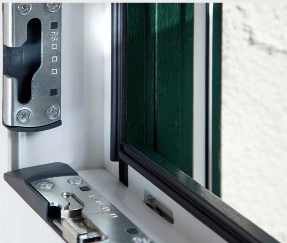
Im Vergleich zu anderen Drehkippschlägen kann der autoPilot PA neben den herkömmlichen Öffnungseinstellungen „Drehen“ und „Kippen“ parallel abgestellt werden. In dieser Position wird der Fensterflügel 6 mm parallel vom Rahmen abgestellt. Der entstehende Lüftungsspalt ermöglicht eine natürliche und sichere Belüftung auch bei Abwesenheit. Denn auch in dieser Stellung ist dieselbe Einbruchssicherheit gegeben wie im geschlossenen Zustand des Fensters – nämlich Sicherheitsstufe EH3.
