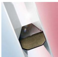
HÖNING-Fenster werden mit einem thermisch verbesserten Randverbund ausgestattet. Im Gegensatz zu herkömmlichen Abstandhaltern aus Aluminium wird durch den thermisch verbesserten Randverbund die Kältebrücke im Randbereich des Isolierglases entkoppelt, was erheblich zur Energieeinsparung beiträgt. Die Gefahr von Tauwasser- und Schimmelbildung wird minimiert.
