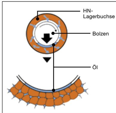
Die HN-Buchse, ein weiteres Beispiel für innovative, von Hitachi entwickelte Technologie, bietet Langlebigkeit und hohe Verschleißfestigkeit. Das äußerst harte Sintermetall der Buchse wird bei der Herstellung im Vakuum mit hochviskosem Öl getränkt. Während des Betriebs sickert Öl aus den Buchsenporen in den Lagerbereich zwischen Bolzen und Buchse, wodurch ein Selbstschmiereffekt entsteht.
