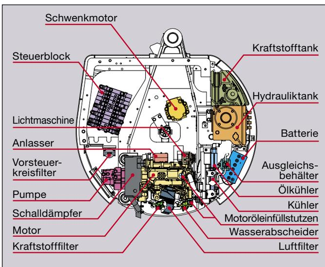
Der ZX22U-2 ermöglicht durch seine Komponentenanzahl einen effizienten und schnellen Zugang zu allen Inspektions- und Wartungspunkten. Die Inspektionspunkte sind außerdem nebeneinander gruppiert, um die tägliche Wartung zu verkürzen.
