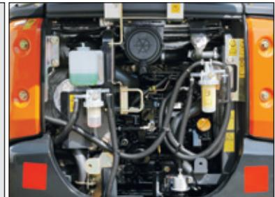
Der neue Motor sorgt für gute Leistung und Geschwindigkeit und läuft dabei noch leiser. Das bewährte Hydrauliksystem mit drei Pumpen ermöglicht gleichmäßige Kombinationsbewegungen des Arbeitsgeräts. Das Laufwerk des ZX18-3 kann in einem Spurbreitebereich von 970 bis 1.280 mm verstellt werden: Eingefahren bietet es hohe Wendigkeit auf engstem Raum und ausgefahren höchste Stabilität.
