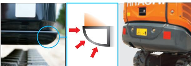
Das bewährte D-Profil schützt den Rahmen wirkungsvoll vor Beschädigungen. Das Gegengewicht ist im Hauptrahmen integriert und bietet so den bestmöglichen Schutz.
