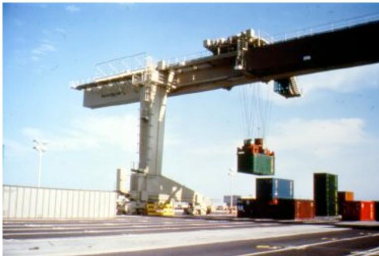
Fascio di prova per gru a cavalletto automatizzate montate su binari (RMG)
