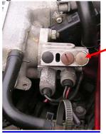
IDLE SCREW BENEATH DUST CAP
