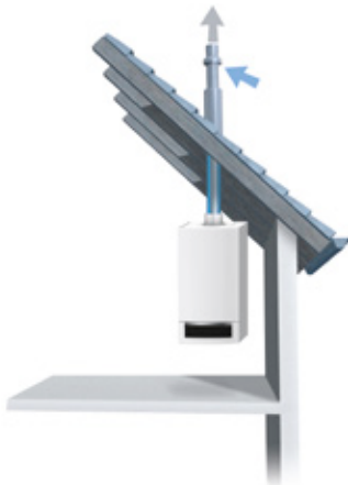
Raumluftunabhängige Aufstellvariante mit Abgasleitung über Dachinstallation
