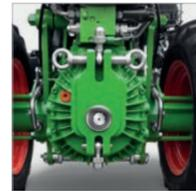
agria-Anbauflansch: einfacher und schneller Anbaugerätewechsel
