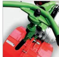
Werkzeuglose Seitenverstellung des Lenkholms mit Schnelleinstellhebel
