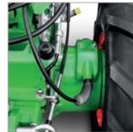
Robuste Lenkbremskupplungen für einfaches Lenken
