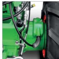
Lenkbremskupplung für einfaches und leichtgängiges Lenken
