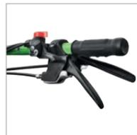
Einfaches Lenken mit Lenkhebel am Griff (bei 3+2)
