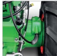
Robuste Lenkbremskupplungen für einfaches Lenken
