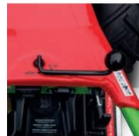
Sicheres Abstellen der Maschine mit zentraler Feststellbremse
