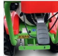
Fahrtrichtungswechsel vorwärts/rückwärts einfach per Fußhebel schaltbar
