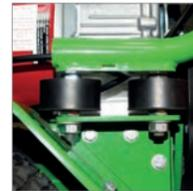
Schwingungsgedämpfter Lenkholm durch Dämpferelemente
