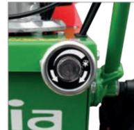
Stufenlose Einstellung der Bürstendrehzahl
