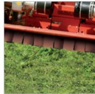
Schutz vor Steinschlag: Wurfkörperprüfung nach DLG
