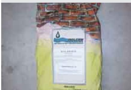
Malta con funzioni di aggrappante ma anche di rasante, a base di calce eminentemente idraulica naturale e inerti selezionati con granulometria massima di 2 mm. Rain Fond 02 vede applicato con consistenza semiliquida o in pasta su pareti e murature per facilitare l'aggancio dell'intonaco successivo. Rain Fond 02 si prepara miscelandolo con acqua fino a 6 kg per 30 kg di prodotto, variandone la consistenza a seconda del tipo di applicazione (spritz o spatola).
