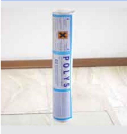
Sigillante specifico bicomponente a base di polisolfuri. Polys C3 viene utilizzato per realizzare giunture elastiche sia orizzontali che verticali, soggetti a movimenti su una grande varietà di supporti come calcestruzzo, legno, metallo.
