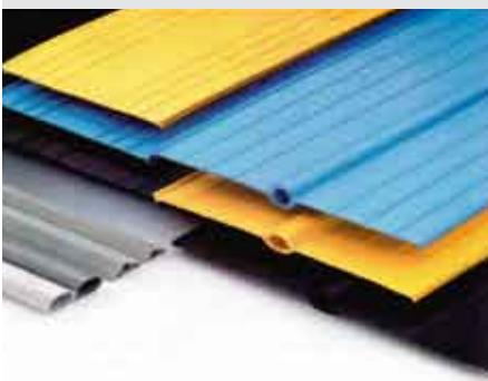
Profilo in PVC piatto, adatto per assicurare la tenuta idraulica delle riprese di getto in cls sia in verticale che in orizzontale. Resistente alle basse temperature (-44° C.). Waterstop in pvc piatto va applicato al centro della ripresa di getto annegandolo nella prima metà del getto. Le giunture vanno eseguite accostando lateralmente le due estremità per circa 10 cm incollandole con il Sigillante K9 o in alternativa saldate a caldo con speciali phon.
