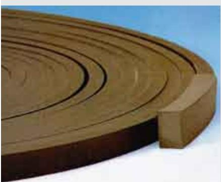
Giunto sigillante impiegato per assicurare la tenuta idraulica delle riprese di getto. Esso è costituito da particolari gomme sintetiche che a contatto con l'acqua aumentano di volume, sigillando eventuali irregolarità e vuoti nelle riprese di getto e garantendone la tenuta all'acqua.
