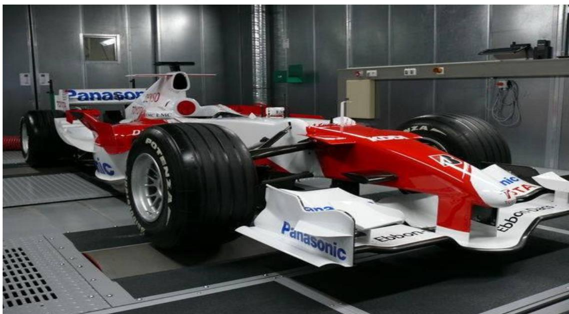
**Aucun problème de hauteur de caisse grâce aux mono rouleaux**
