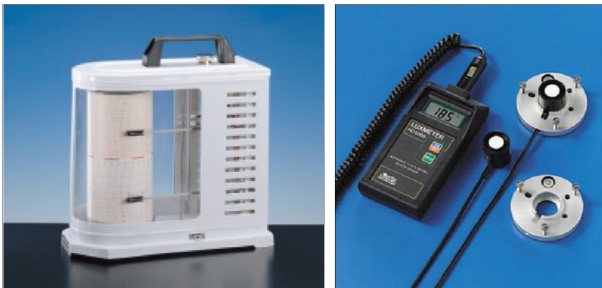
Figura 3.2. Sinistra: termoigrografo (LSI-Lastem, Milano); Destra: luxmetro (Delta Ohm, Padova)
