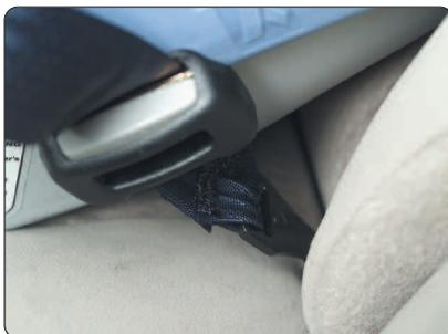
Gancho flexible LATCH que usa una barra de anclaje
