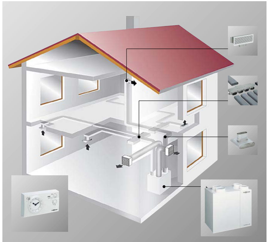
Bild 25: Vitovent 300 Wohnungslüftungs-System mit Wärmerückgewinnung und Luftvorerwärmung sorgt im Sommer und Winter für ein behagliches Raumklima, reduziert den Lüftungswärmebedarf und senkt die Heizkosten
